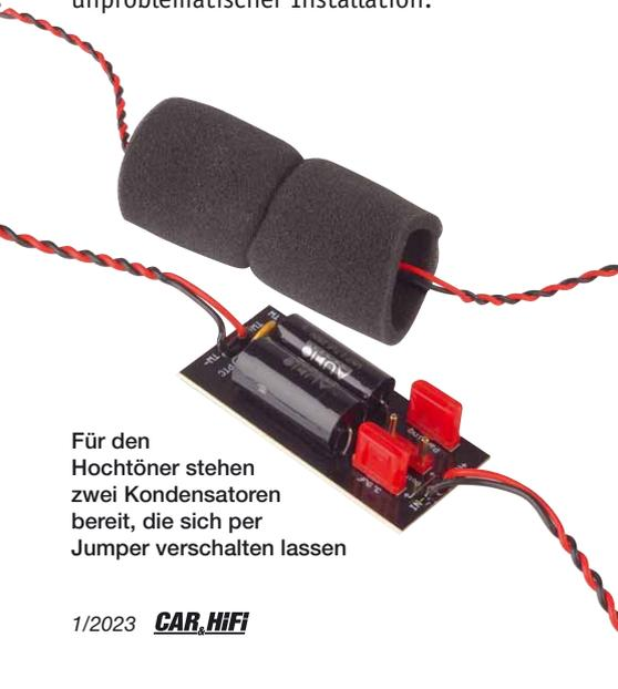
Für den Hochtöner stehen zwei Kondensatoren bereit, die sich per Jumper verschalten lassen
