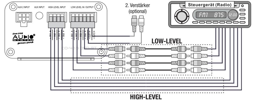
**7. Pre-Out:** Der Verstärker verfügt über einen 2-Kanal Ausgang, um andere Verstärker zu betreiben.
