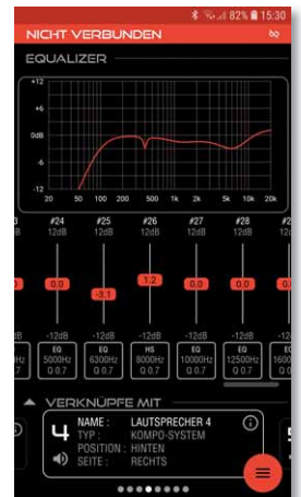
Equalizer: Mittig lassen sich die Bänder, unten die Kanäle durchwischen; Antippen öffnet die EQ-Parameter
