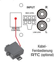
Mit angeschlossenem RTC (Kabelfernbedienung) kann der Subwoofer vom Fahrerbereich geregelt werden.
