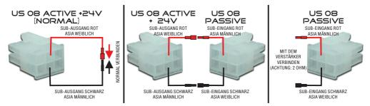
Um den US O8 PASSIVE an den ACTIVE anzuschließen, verbinden Sie die 2 Asia-Steckverbindungen miteinander (siehe Abbildung). Sie können den US O8 PASSIVE auch an einer anderen Endstufe betreiben, in dem Sie die SUB-Eingänge verwenden.
