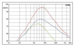
Die Aktivelektronik bietet neben der Phasenumkehr einen Bassboost und ein Tiefpassfilter
