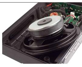
Der 20-cm-Woofer in Flachbauweise arbeitet mit großer 50-mm-Schwingspule und Alumembran, an den Seiten sitzen schlanke Passivmembranen
