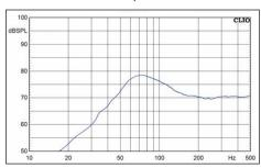
Der passive US 08 zeigt für das kleine Volumen eine recht tiefe Abstimmung mit einer Grenzfrequenz von 54 Hz
