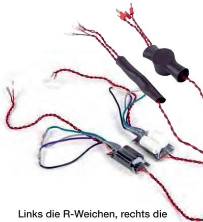
Links die R-Weichen, rechts die X-Weichen mit weißen Kondensatoren und großer Luftspule
