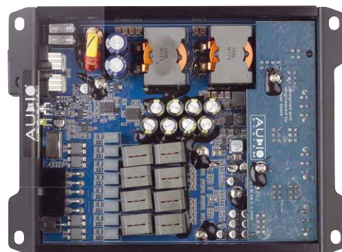
Alles doppelt auf kleinstem Raum: Doppeltes Stepup-Netzteil und 8 Drosselspulen
